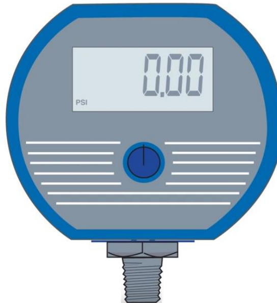
Digitální manometr s piezoelektrickým prvkem
